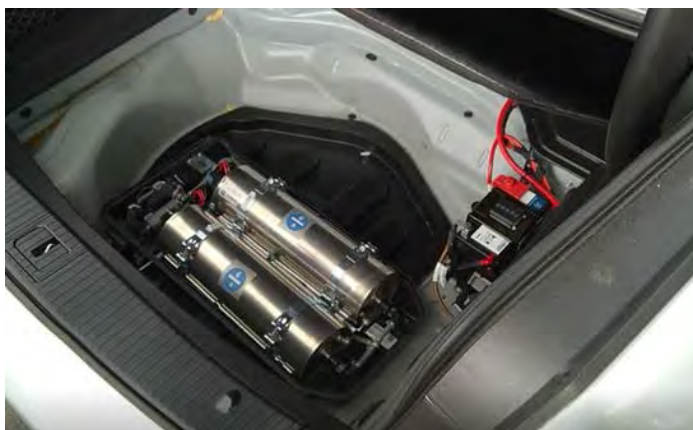
Abbildung 25: ASDS-System Prototyp verbaut in der Reserveradmulde
