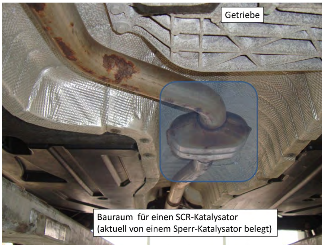
Abbildung 54: Fahrzeugunterboden BMW X3 EU6b (F25) mit Sperr-Katalysator (CU-Zeolith) – Bauraum für den SCR-Katalysator ist farblich hervorgehoben
