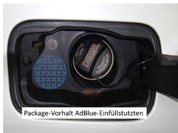
Abbildung 58: Tankdeckel mit geometrischem Vorhalt für den Adblue-Einfüllstutzen
