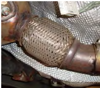
Abbildung 10: Schwingungskompensator - Faltenbalg in der Abgasanlage eines BMW 320d EU5, Baureihe F30
