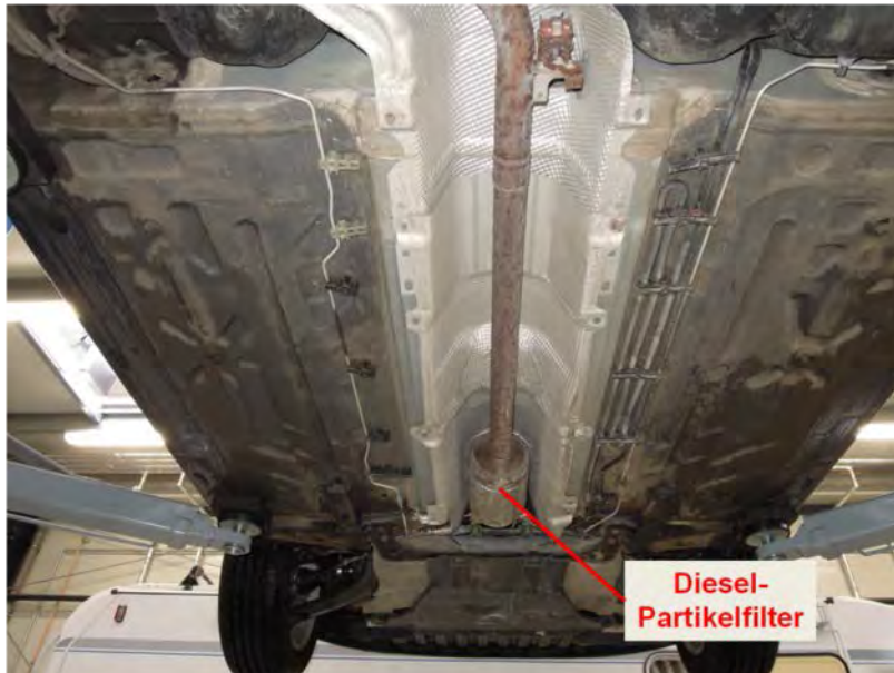
Abbildung 66: Platzverhältnisse im Unterbodenbereich
