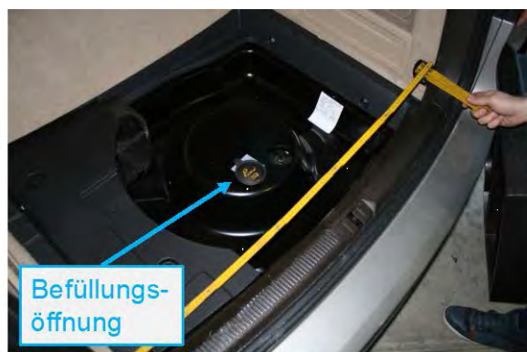
Abbildung 43: Adblue-Tank im Kofferraum, Passat Euro6b
