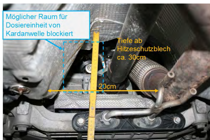
Abbildung 46: Übergang von Motorraum zu Unterboden, Tiguan Euro5
