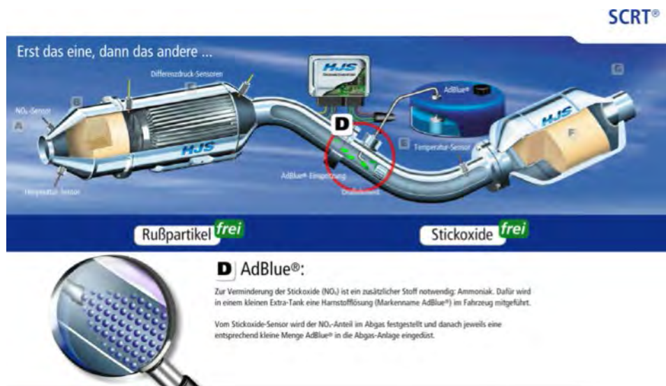
Abbildung 35: Funktion SCR-Reduktionsmittelzuführung und Aufbereitung
