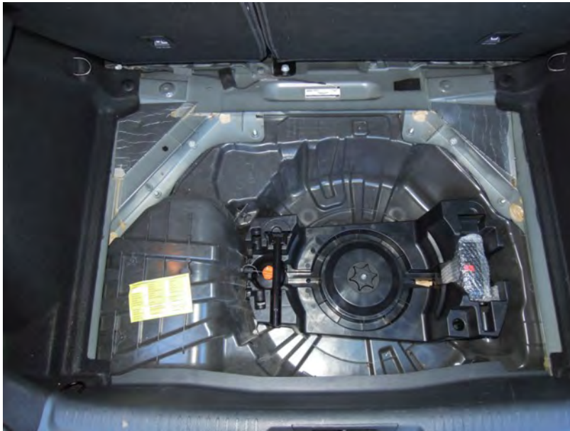
Abbildung 82: Platzangebot im Innenraum (Adblue-Speicher / Ammoniakspeicher)
