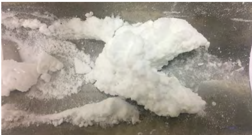
Abbildung 4: Ablagerungen durch Adblue-Einspritzung bei Temperaturen unterhalb von 180^\circ\text{C} (Quelle: Börnhorst, Deutschmann, ITCP, KIT)
