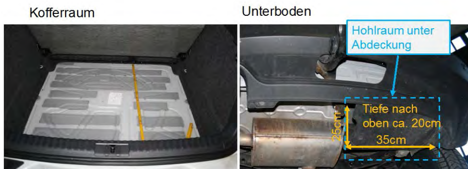
Abbildung 47: Platzierungsmöglichkeiten für Adblue im hinteren Fahrzeugbereich, Tiguan Euro5
