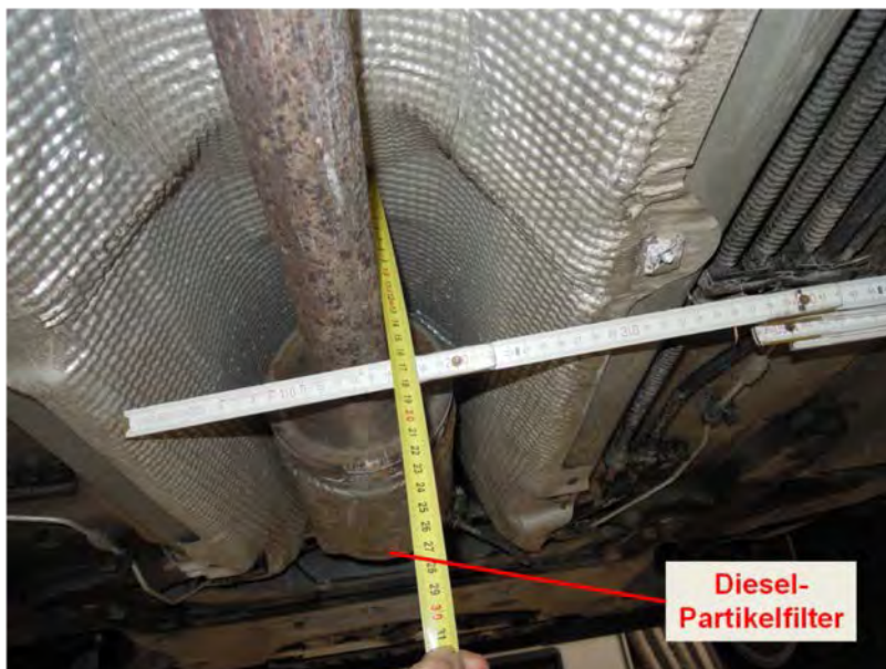
Abbildung 68: Platzangebot im Unterbodenbereich
