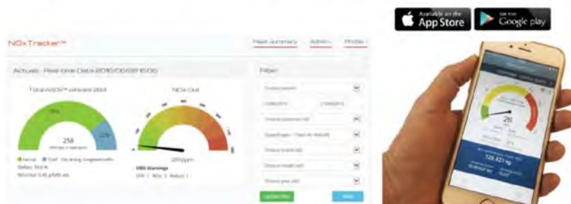
Abbildung 27: ASDS-NO x Tracker Monitor- und Diagnosekonzept (Quelle: Amminex)
