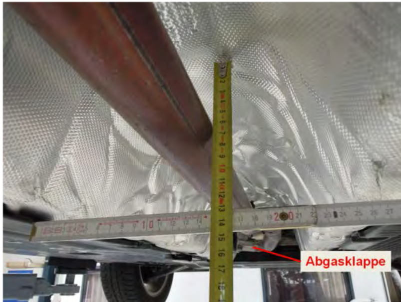
Abbildung 80: Platzangebot im Unterbodenbereich
