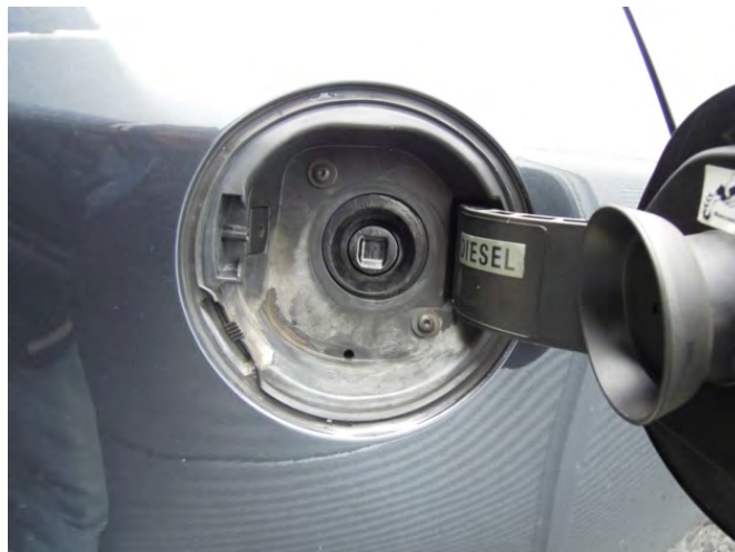
Abbildung 72: Einfüllöffnung für Dieselkraftstoff
