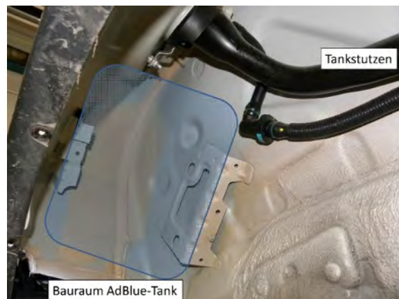
Abbildung 57: Radhaus rechts hinten des BMW X3 EU6b (F25) – ein möglicher Bauraum für das Adblue-Tanksystem ist farblich hervorgehoben
