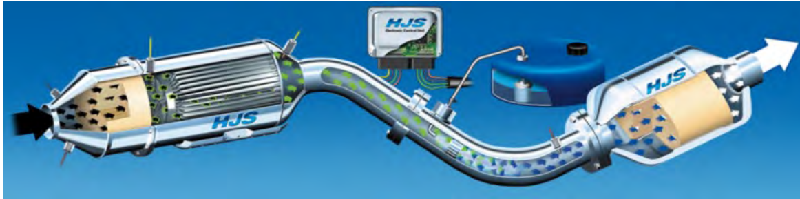
Abbildung 31: SCRT®-System (Quelle HJS)
