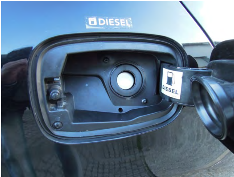
Abbildung 83: Einfüllöffnung für Dieselkraftstoff
