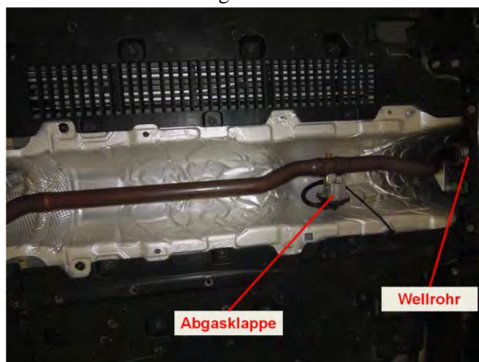
Abbildung 78: Platzverhältnisse im Unterbodenbereich
