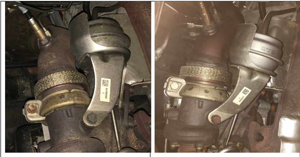
Abbildung 6: Abgasturbolader mitsamt p_4 , T_4 Sensorik von oben betrachtet mit Wastagesteller über Druckdose.
