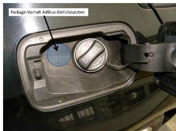
Abbildung 52: Tankdeckel mit geometrischem Vorhalt für den Adblue-Einfüllstutzen
