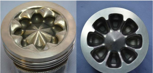
Bild: Gedruckte Dieselmotorkolben mit innovativen Muldenformen
