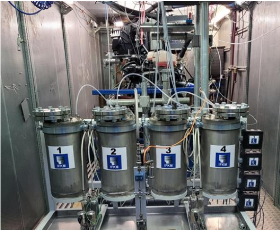
Bild: Online-Kraftstoffblendanlage für vier Kraftstoffe
