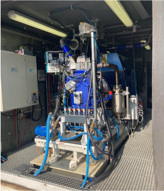
Bild: Einzylindermotor mit Wasserstoff- und Ammoniak-Infrastruktur am IFKM
