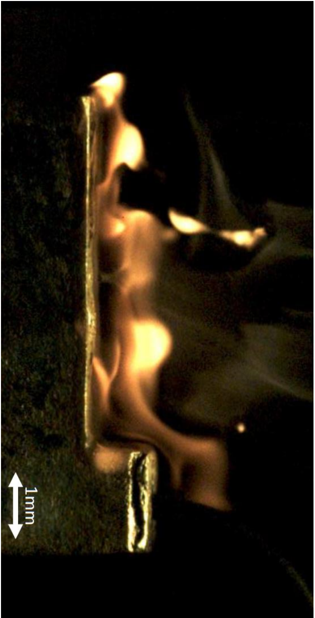
Bild: Ölprobenträger für ein Projekt im Bereich ottomotorische Vorentflammung (ebenfalls Finalteilnehmer für IFKM Fotopreis 2022)
