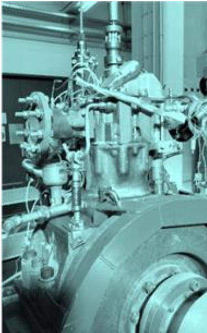
Bild: Einzylinder-Forschungsaggregat mit 4l Hubraum und speziellem Gaseinblaseventil am IFKM
