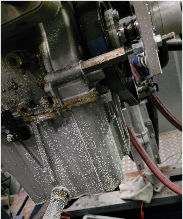
Bild: Eiskristallbildung am Motor bei der Kalterprobung von reFuels-Kraftstoffen (ebenfalls Finalteilnehmer für IFKM Fotopreis 2022)
