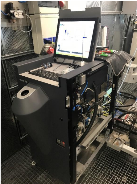
Bild: FTIR vom Typ versa06 von IAG bei der Inbetriebnahme am IFKM
