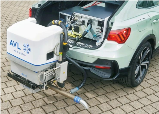
Bild 1: Fahrzeug mit zwei separaten PEMS-Anlagen montiert auf Anhängerkupplung und im Kofferraum
