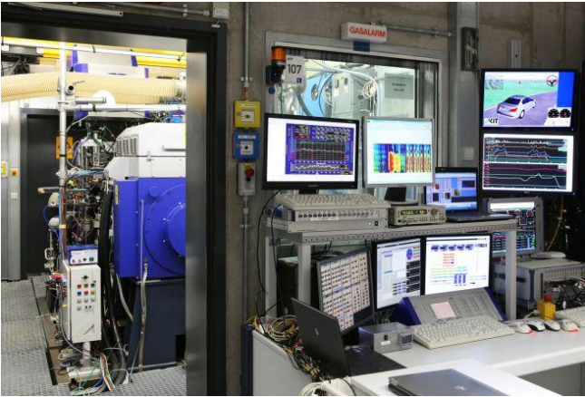
Bild: Motorenprüfstand am IFKM zum dynamischen Betrieb des Versuchsträgers.
