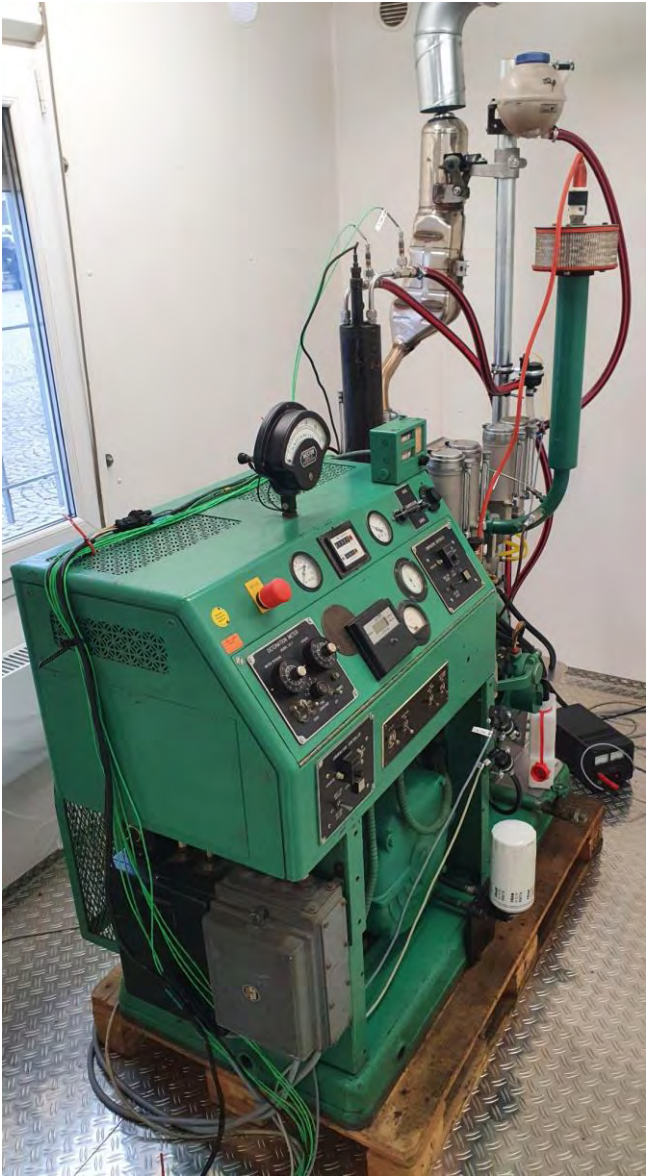
Bild: CFR-Forschungsmotor zur Bestimmung von Oktanzahlen. Der Motor wurde für dieses Forschungsvorhaben im überarbeiteten Prüfstand 608 am Campus Ost aufgebaut.
