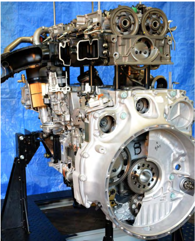
Schnittmodell (Demonstrator) eines Daimler OM-471 Nutzfahrzeugmotors [Modell 2019 am IFKM angefertigt]
