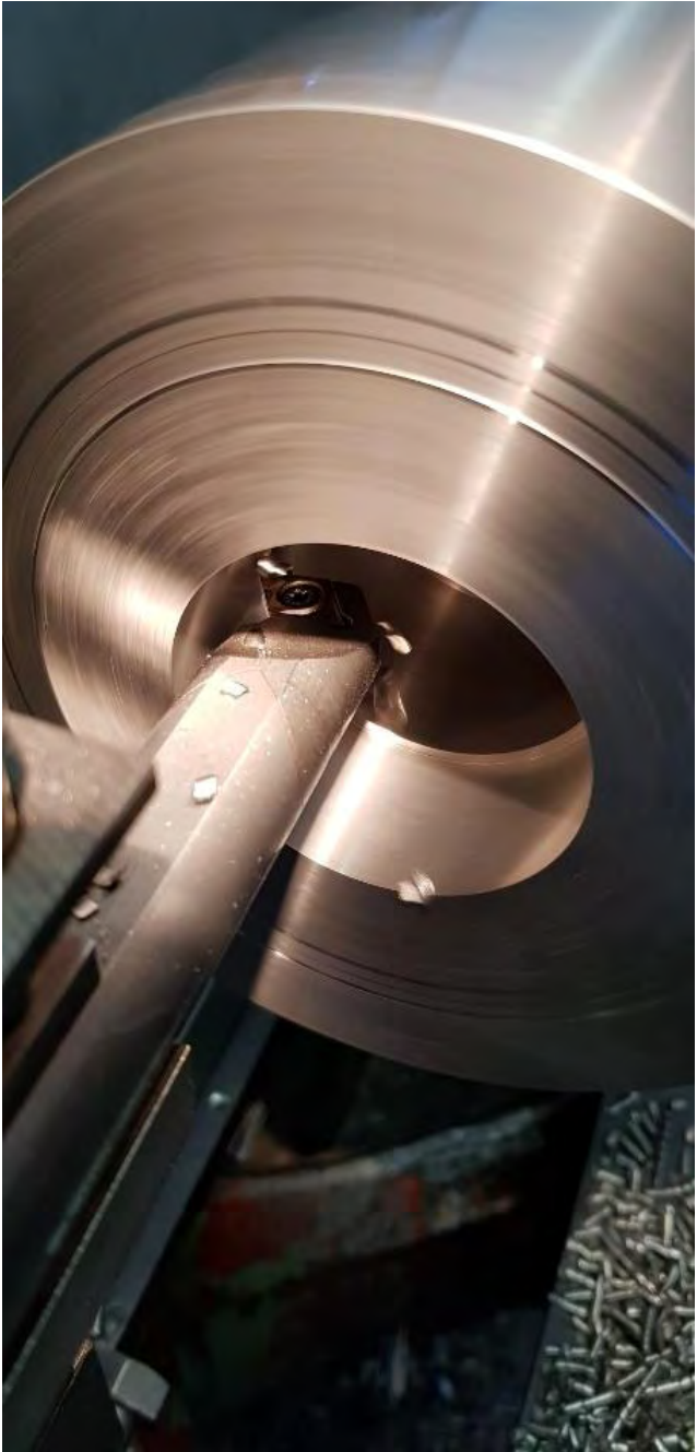
Drehbearbeitung eines Werkstücks (Herstellung Zündkammer)
